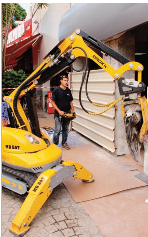
Une simple console permet de commander avec précision le Brokk 100.
