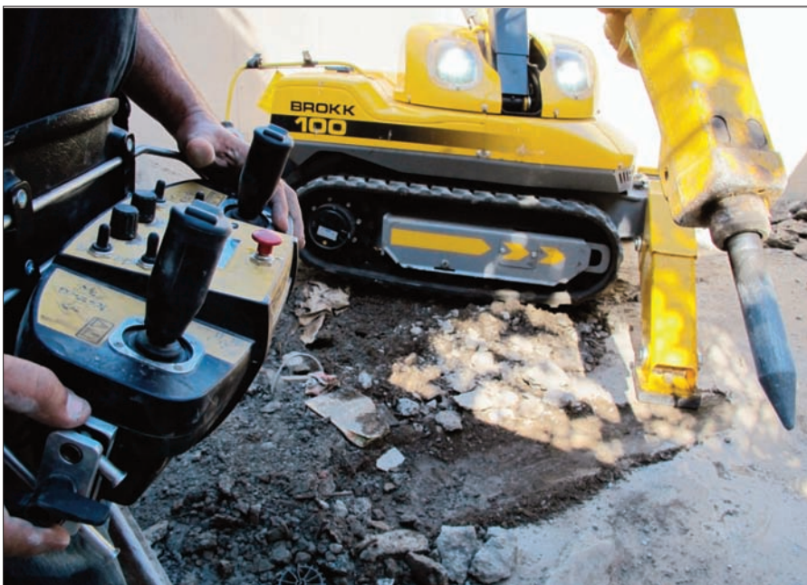
Le Brokk 100 est télécommandé via un boîtier doté de deux joysticks et de multiples boutons de commande.
